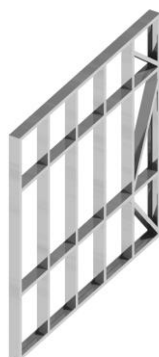
Struttura parete Pressemblata off-site
